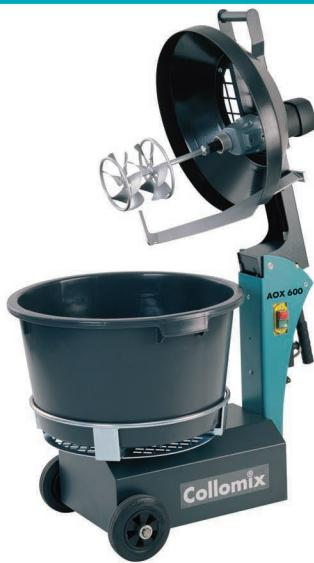
Uređaj koji se sastoji od rotirajuće posude za mješanje s mogućnosti vađenja i prenošenja te električno pokretane šipke za mješanje, također sadrži fiksno montirani strugač koji se kreće uz rub posude. Brz i temeljit, posebno je prikladan za mase za ljepljenje, filere, premaze, gipsane mase, žbuke, mortove.
